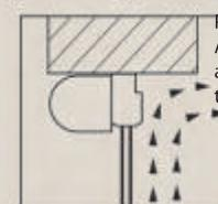
Předokenní roleta od firmy Alukon je umístěna vně okna a tím je zamezeno ztrátám tepla.
