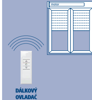
Ovládání dálkově pomocí motoru s baterií a solárním panelem (bez elektropřípravy)
